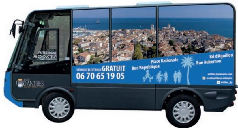
C'est le **Mini Bus Geco** qui a été choisi auprès de la société Mobilité Plus. Conçu par ASPP Technology, équipé de batteries Lithium, il se conduit avec un permis B. Avec une autonomie de 80 km minimum sur une seule charge et un petit gabarit, il est particulièrement adapté à la conduite en centre-ville et en zone piétonne. Sa configuration permet un accès facile à bord (marchepied mobile, volume important, plancher bas...).
